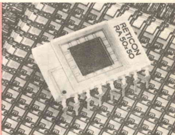
Fig. 4 - Vista ravvicinata del sensore d'immagine Reticon RA 50 x 50. Sullo sfondo della fotografia è riportato un forte ingrandimento della superficie del sensore.
